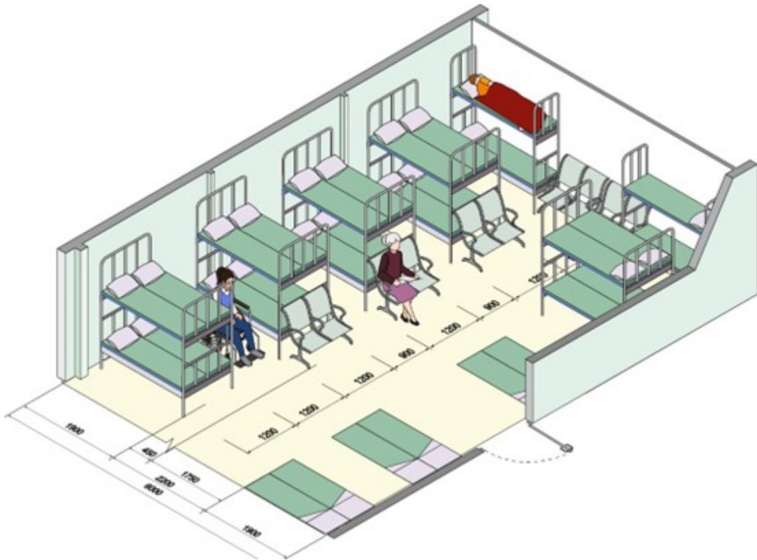
Рисунок 2.6. Схема облаштування укриття житлового будинку
