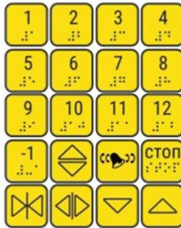
Рисунок 1.44. Приклад наліпок на кнопки керування ліфтом
