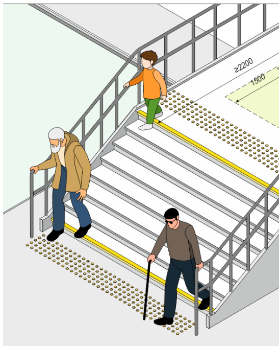
Рисунок 1.15. Приклад облаштування поручнів на сходах
